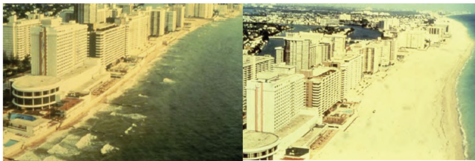
Miami Beach, Φλόριντα, πριν (δεκαετία 1960) και μετά τον εμπλουτισμό (δεκαετία 1980). Αρχικά είχαν δοκιμάσει προβόλους, αλλά η διάβρωση συνεχίστηκε (από την ομιλία του Κώστα Συνολάκη).
